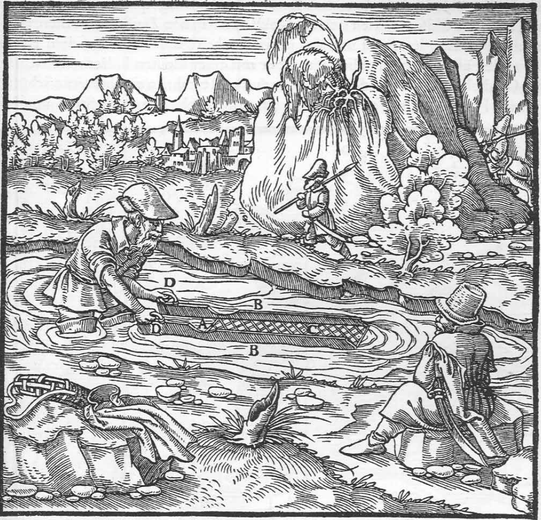
Das Bodenbrett A. Die Seitenbretter B. Die eisernen Drähte C. Die Handhaben D.
