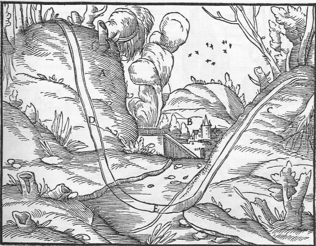
Das Berggehänge A, C. Ein Tal B. Der Gang D, E, F.
